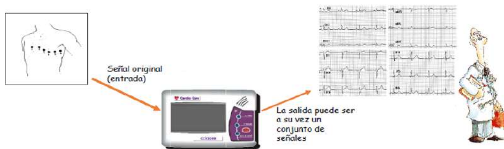
Figure 1.13: Sistema de registro, visualización y extracción en un electrocardiograma.
