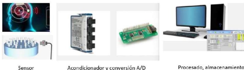
Figure 1.1: Elementos de que se compone un dispositivo de adquisición de datos.
