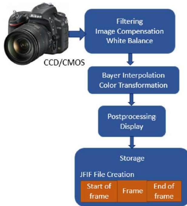
Figure 1.9: Proceso de captura y guarda de imagen.
