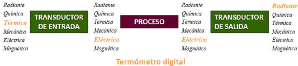
Figure 1.14: Proceso de transducción en un termómetro digital.
